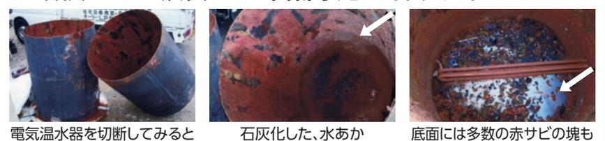
電気温水器を切断してみると 石灰化した、水あか 底面には多数の赤サビの塊も
